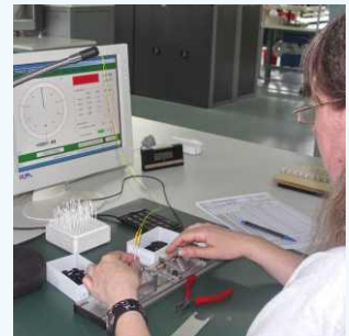
Justage von Sensoren, PC-gesteuert
